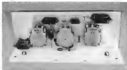
Bild 14. Ansicht der Verdrahtung der Klang- und Lautstärkeinsteller
